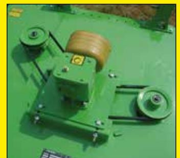
Die Rotoren werden durch zwei Keilriemen angetrieben.
