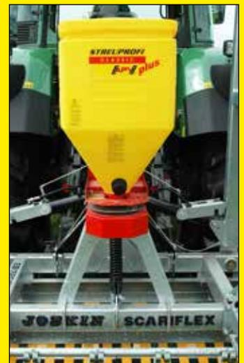
Im Gegensatz dazu wird auf der pneumatischbetätigten Sämaschine das Saatgut durch einen Streunocken in einem Luftstrom gestreut. Die Saat wird dann durch die Schläuche auf die Prallteller geleitet, die sich vor den flexiblen Zinken befinden.
