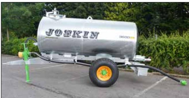
Die AQUATRANS/AQUATRANS XL Wasserfässer können mit einer volumetrischen Pumpe zum Befüllen ausgerüstet werden, um ein schnelles und autonomes Befüllen des Fasses zu ermöglichen.
