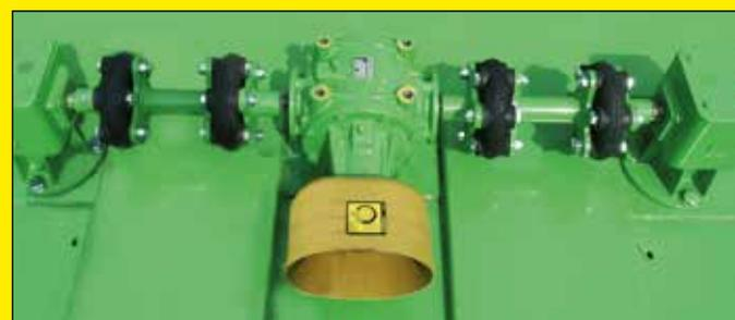
Kraftübertragung mit vierfachem Torsionsschutz
