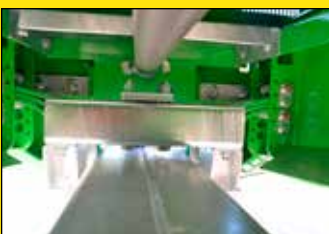
Federung der Deichsel durch parabelförmige Blattfedern
