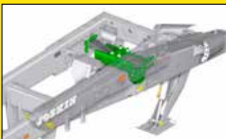
Federung der Deichsel durch parabelförmige Blattfedern
