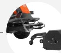
Die Rider der 300er und 400er Serie sind mit einem Befestigungsrahmen ausgestattet, mit dem Sie besonders einfach zwischen Mähdeck und frontmontierten Werkzeugen wie Schlegelmäher, Kehrbürste, Schneefräse und Schneeräumschild wechseln können
